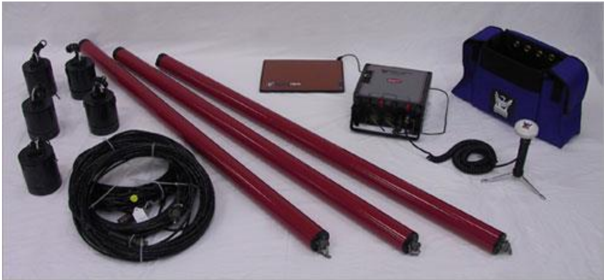
Figure 2. 1: Système MT de Phoenix V5-2000. De gauche à droite : des électrodes impolarisables (en plomb, plomb-chlorure (Pb - PbCl)), câbles de bobine d'induction, bobines d'induction MTC-50, batterie, unité d'enregistrement, boîtier de l'unité et antenne GPS (voir : http://www.phoenixgeophysics.com/products/systems/ssmt/ ).
